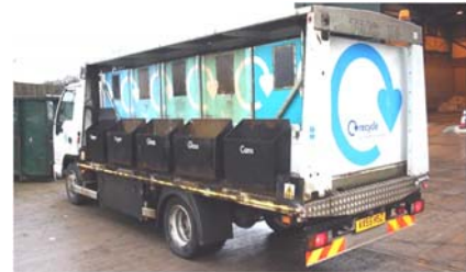
Εικόνα 4-2: Εξωτερική διαμόρφωση και εσωτερικοί χώροι ΠΣ. Όχημα (κινητός κάδος / mobile skip) που χρησιμοποιείται σε απομονωμένες περιοχές (τοποθετούνται σε συγκεκριμένη τοποθεσία για λίγες ημέρες και συλλέγονται αργότερα)
